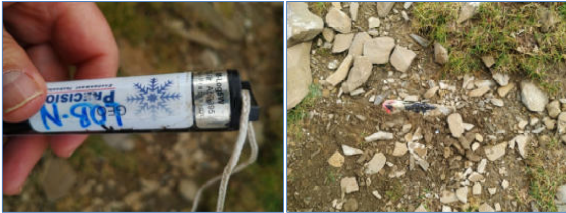
Sustitución del termómetro de la cara Norte de Custodia.
