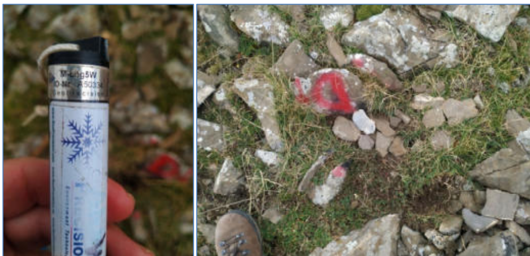
Sustitución del termómetro de la cara Oeste de Custodia.
